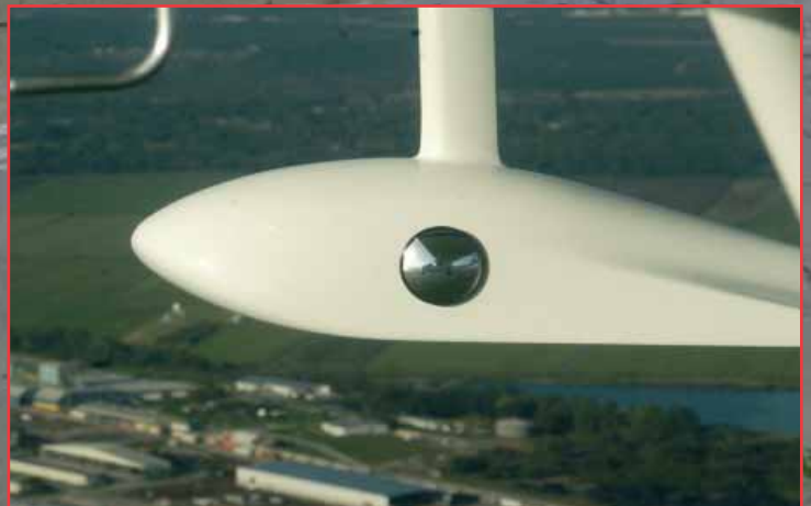
Optische Kontrolle: Ist das Fahrwerk draußen? der Spiegel sagt's.
