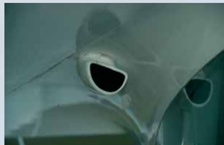
Lutzhutze: Druckluft für die Unterseite.
